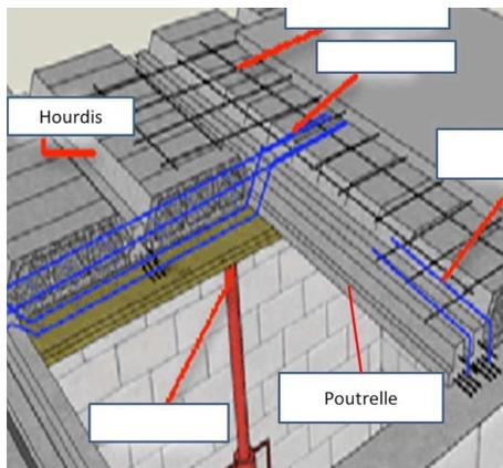
**HOURDIS** : bloc de remplissage posé entre les poutrelles d’un plancher.
